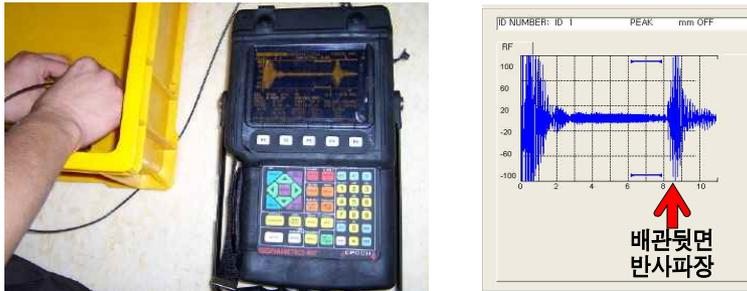
○ 실험2) 시험체-Steel Pipe, 조건-대기중 상태, 탐촉자-C543
